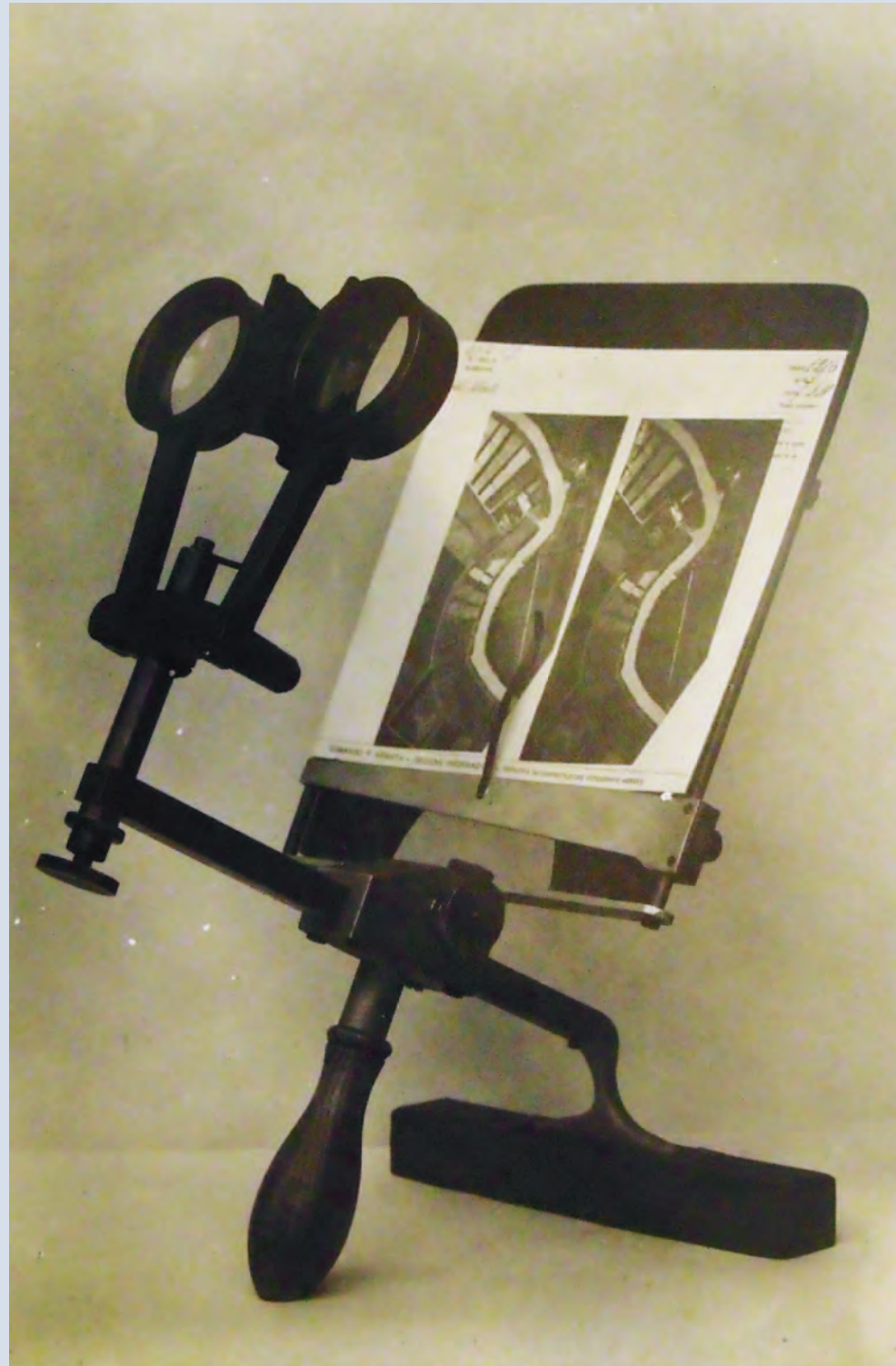
Figura 3. Strumento per la stereoscopia e la fotointerpretazione di immagini aeree zenitali, AFMS, Fondo Trener, b. 1 bis, Documenti militari, Attrezzature fotografiche e fasi di sviluppo e interpretazione.
